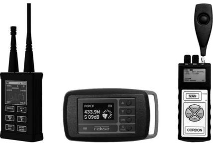
Рис. 3. Образцы цифровых индикаторов поля
