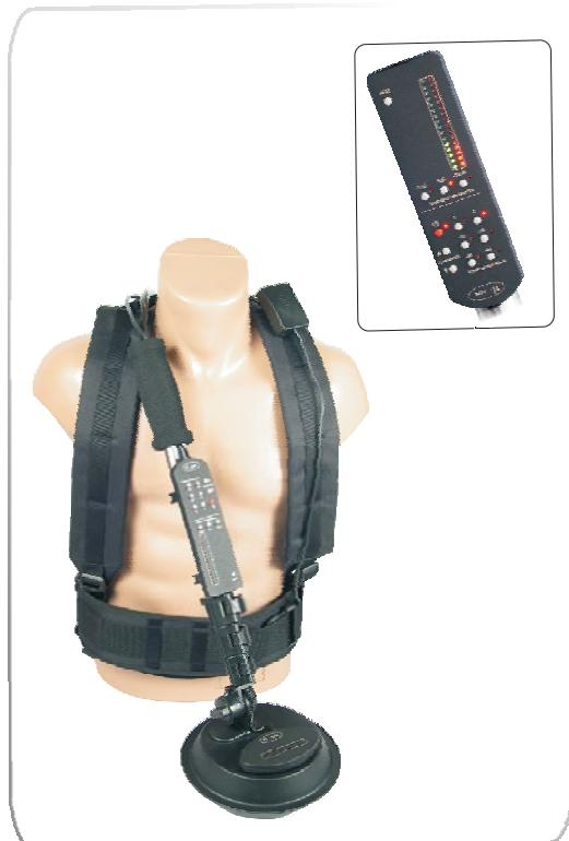
Все современные электронные устройства состоят из компонентов, содержащих полупроводниковые элементы (диоды, транзисторы, микросхемы и т.п.) Эти компоненты имеют характерные свойства - при облучении внешним радиосигналом, электронные устройства переизлучают сигнал на удвоенной и утроенной частотах зондирующего сигнала.
