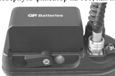
Рис.8 Вид на установленный аккумулятор. Фиксатор закрыт.
