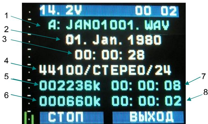
Рисунок 2.13 Вид экрана с информацией о воспроизводимом файле.
