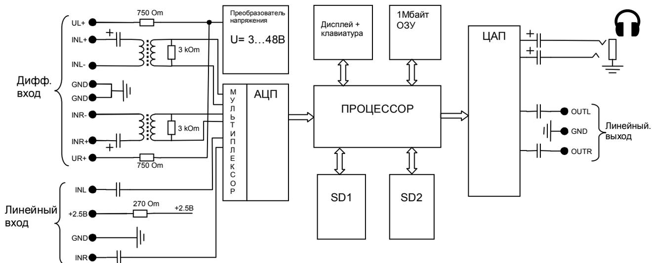
Рисунок 1.1 . Блок-схема аудиорегистратора
