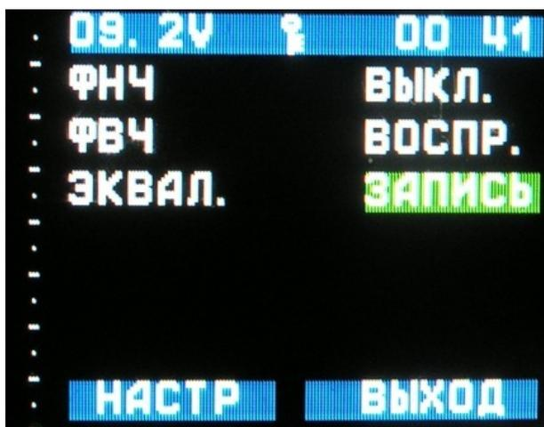
Рисунок 2.8 Вид экрана с настройкой включения фильтров.
