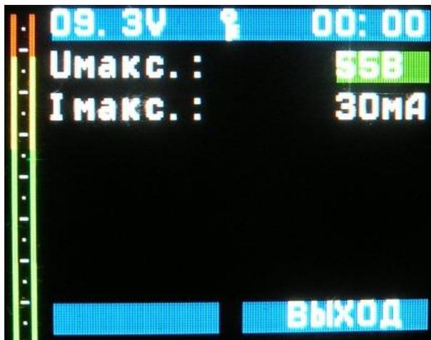
Рисунок 2.7 Вид экрана при задании предельных значений напряжения и тока линии.
