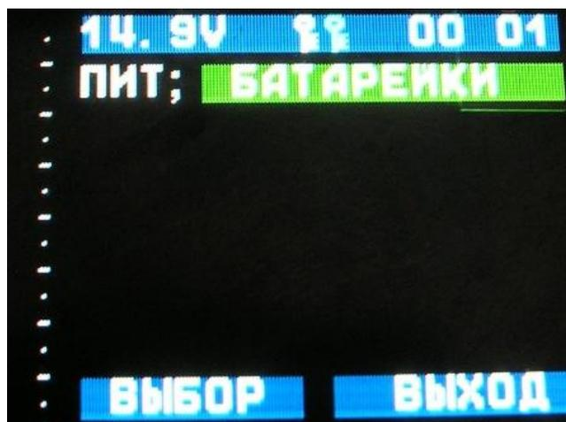
Рисунок 2.19 Вид экрана при задании типа источника питания.
