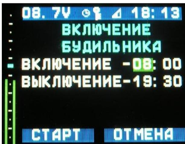
Рисунок 2.5 Вид экрана при настройке будильника.
