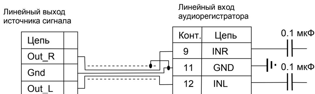
Рисунок 3.1 Подключение источника сигнала к линейному входу аудиорегистратора.
