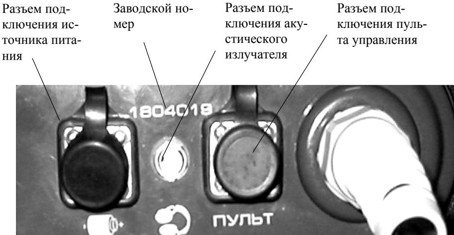
Рис. 4 Маркировка блока приемопередатчика.
