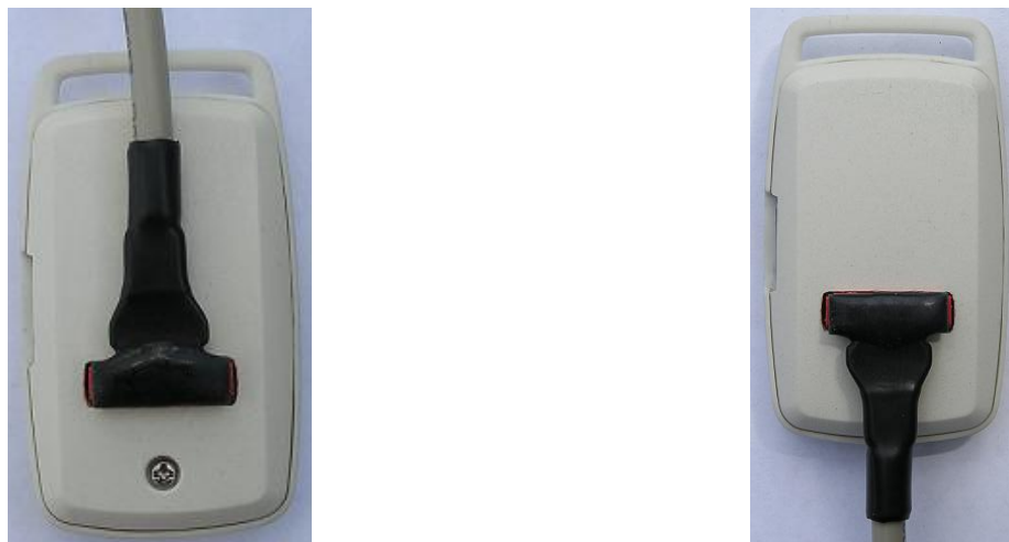
Рисунок 5. Способы подключения сетевого/USB адаптера к диктофонам ЛАБИ.423363.013 «СОРОКА-03», «СОРОКА-04»
