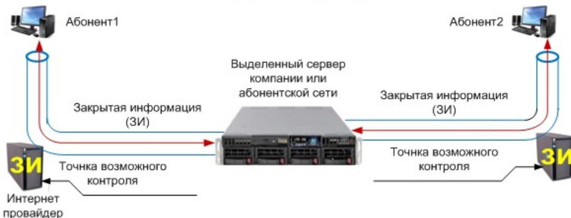
После установления соединения начинается процесс формирования ключевой информации, а по его окончании организуется зашифрованный VPN канал связи между сервером и абонентом. В дальнейшем все процессы происходят под защитой первого контура шифрования, который обеспечивает:
