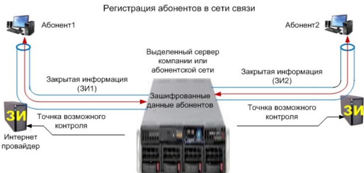
Все необходимые регистрационные данные абонентов хранятся на сервере в зашифрованном виде. Системы защиты не позволяют получить их даже при попадании оборудования в руки противника. Сервер работает под управлением специально разработанной операционной системы DNLinux.
