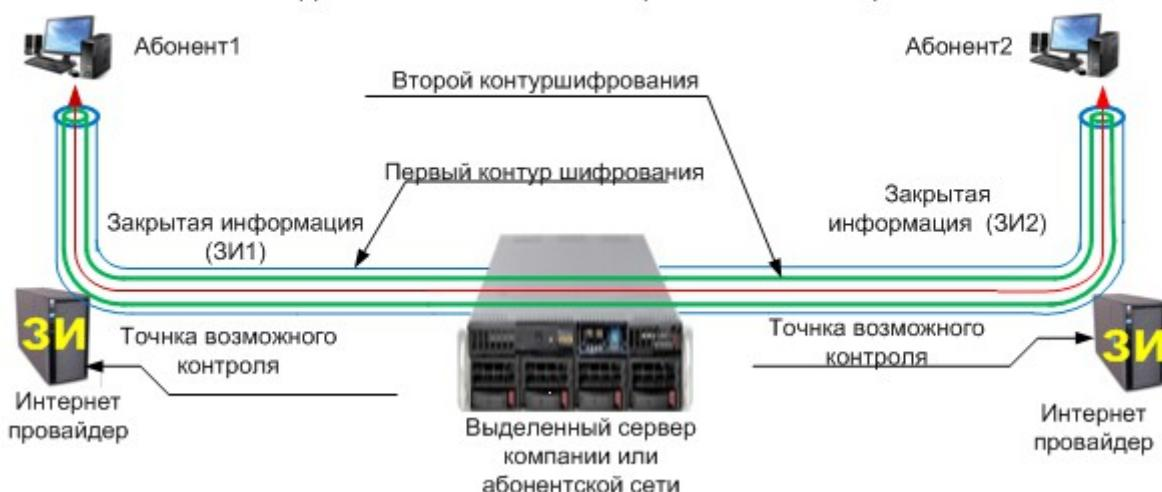
Этот режим обеспечивает самый высокий уровень защищенности информации. При соединении (абонент-абонент) внутри первого контура шифрования формируется второй, в работе которого сервер уже не участвует. Информация шифруется дважды разными алгоритмами. Процесс формирования сеансовых ключей второго контура шифрования проходит под защитой первого и противник его не видит.
