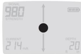
Сигнал звука: когда вы перемещаетесь в пределах  $45^\circ$  от центра излучения электромагнитного поля, высота звукового тона будет изменяться. По мере приближения к трассе звуковой тон повышается, и высота достигает максимума, когда Приёмник находится точно над трассой. Вне зоны в  $45^\circ$  высота и громкость звука не изменяются.
