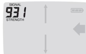
**2. Уровень заряда батарей:** Когда до полного разряда батарей остаётся (по оценке) менее 1 часа, на индикаторе батареи высвечивается только контур без внутренних сегментов. Когда полезный заряд батарей исчерпан, экран гаснет, и индикатор батарей перед тем, как Приёмник отключится, начинает мигать. Ожидаемая длительность работы от одного комплекта из двух щелочных элементов питания типа D составляет 60 часов.
