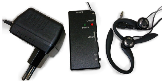
Рис.2. Беспроводные телефоны в составе: зарядное устройство (ЗУ2), приемное устройство (ПРМ), головные телефоны.
